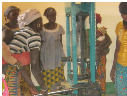
円筒を押し上げながら圧搾するため、破損状態では作業できません。（タンポンガ村）
